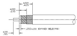
2. INSERT CABLE INTO SOLDER FERRULE UNTIL BRAIDS SEAT IN FERRULE. THEN SOLDER BOTH CABLE BRAIDS TO FERRULE WHERE SHOWN. TRIM CABLE DIELECTRIC FLUSH WITH FACE OF
