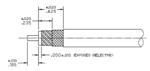
2. SLIDE CLAMP NUT OVER CABLE AS SHOWN. INSERT CABLE INTO SOLDER FERRULE UNTIL CABLE DIELECTRIC IS FLUSH WITH FACE OF FERRULE. THEN SOLDER BOTH CABLE BRAIDS WHERE SHOWN. SLIDE DIELECTRIC STOP OVER CABLE CENTER CONDUCTOR AND SOLDER CONTACT FLUSH AGAINST STOP TO DIMENSION SHOWN.
